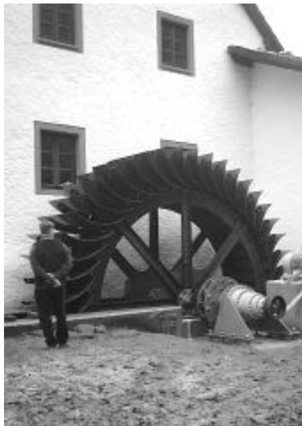
Roue à augets 5 : roue par dessus de 18kW à Schladt (Allemagne), diam 6m larg 1,5m
