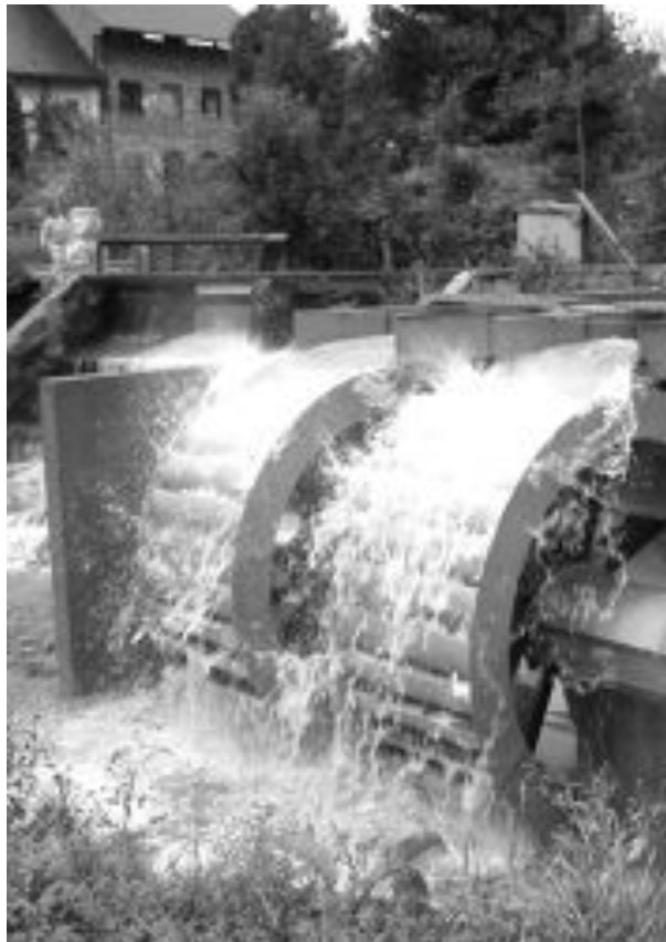
Roue à augets 4 : 2 roues par dessus de 9kW à Steinhaus(Pologne), diam 3,5m larg 1,5m
